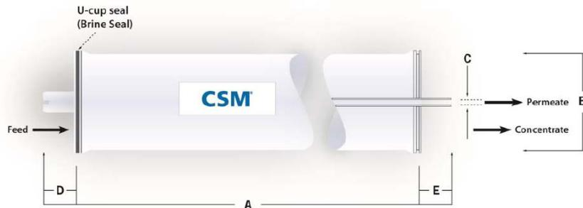
1. Каждый мембранный элемент поставляется в комплекте с одним уплотнительным кольцом линии концентрата, одним пермеатным адаптером и четырьмя прокладками типа O-ring.
