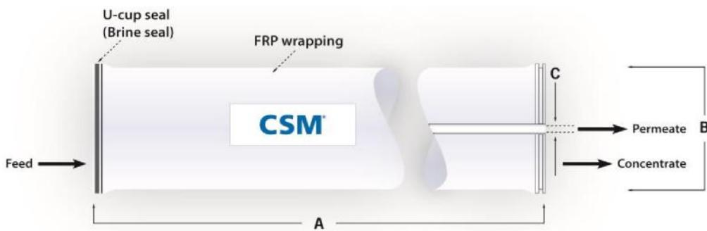
1. Каждый мембранный элемент поставляется в комплекте с одним уплотнительным кольцом линии концентрата, одним пермеатным адаптером и четырьмя прокладками типа O-ring.
