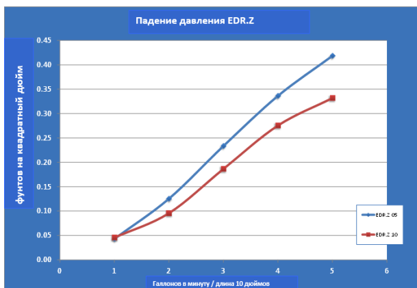
Рисунок 2: Производительность потока в чистой воде на основе фильтра длиной 10 дюймов (25 см)
